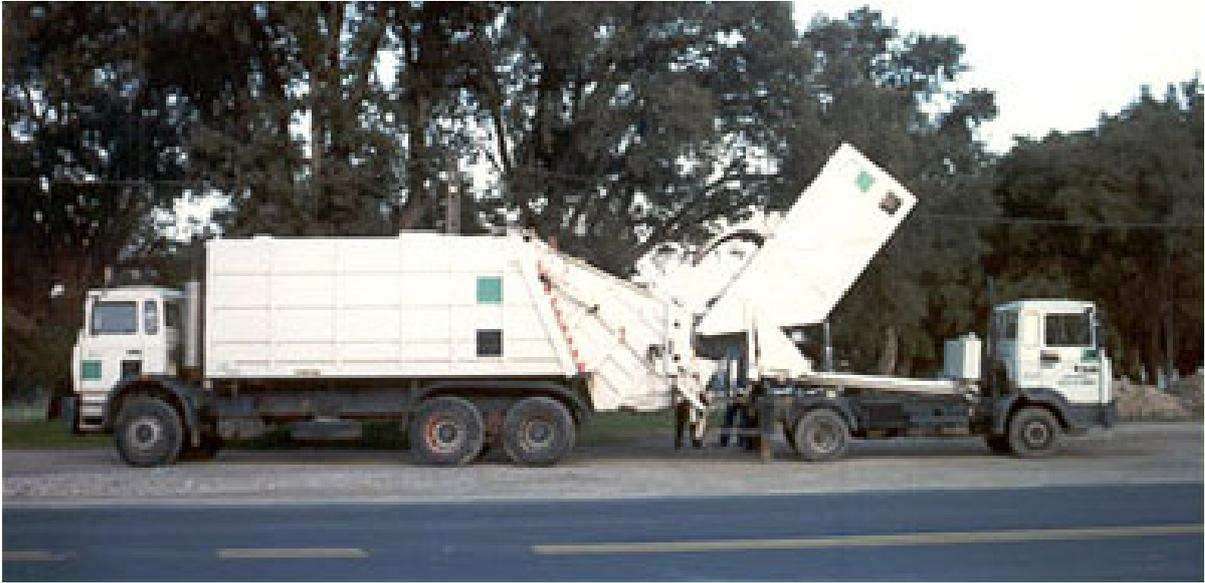
*En la imagen se observa la nodriza (camión de amplio volumen destinado a recoger la carga de un satélite) recibiendo la carga de un satélite (camión más pequeño que se encarga de la recogida los residuos de pequeñas poblaciones).*
