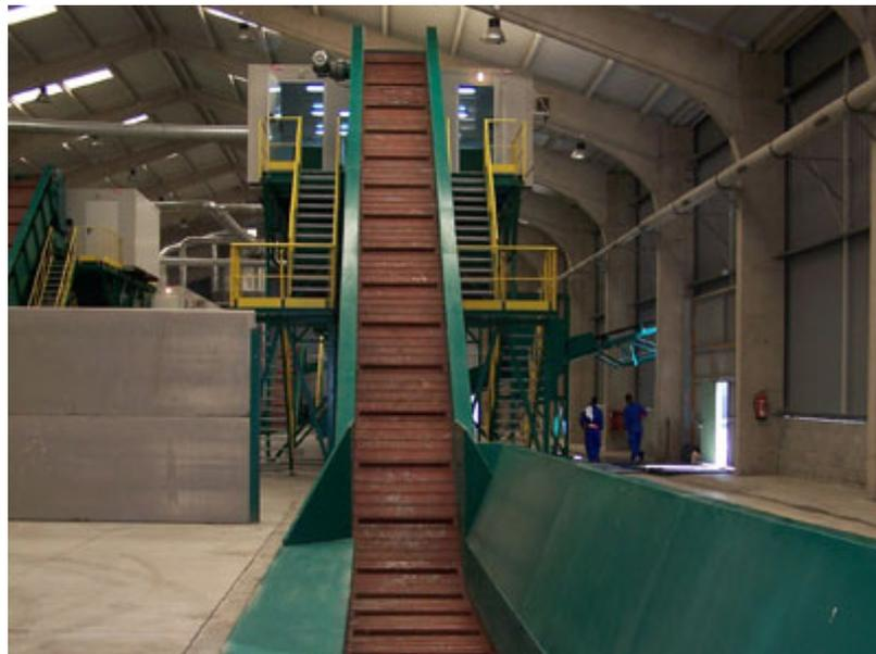
*Inicio de la cinta transportadora, donde se produce la carga desde la playa de descarga hacia el triaje primario, donde se separan los voluminosos que pueden entorpecer el resto del proceso.*
